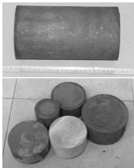
图1 感应凝壳熔炼制备的 TiAl 合金铸锭
