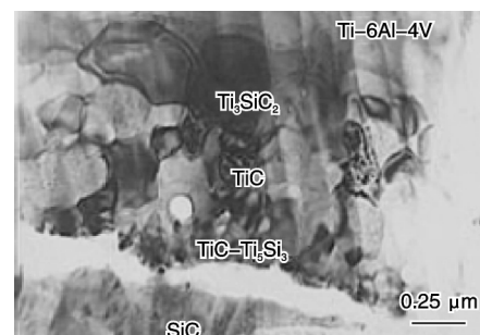
图 2 SiC 纤维表面无 C 涂层的 SiC f /Ti-6Al-4V 界面反应区 TEM 照片
