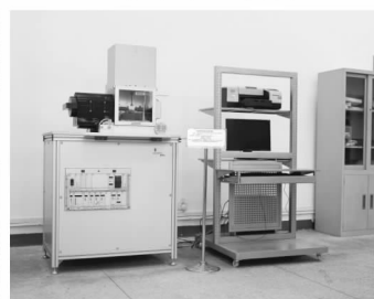
德国SRV摩擦磨损 测试系统
