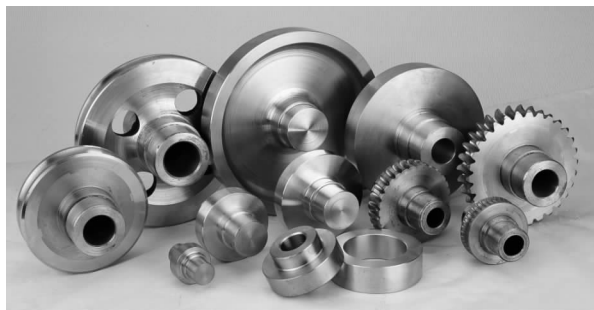
铸造KK铝青铜合金零件
