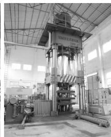
1600吨立式挤压机 (自行研制)
