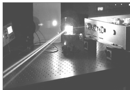
图 3 利用准周期介电体超晶格研制的红、绿、蓝三基色(白光)全固态激光器原型
