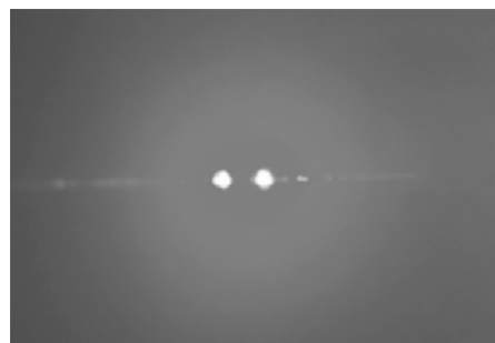
图 6 倍频双聚焦的实验照片
