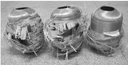
图 4 芳纶Ⅲ纤维 \phi 150 mm 容器爆破形貌
