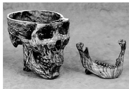
图2 LOM制造的头骨模型和下颌模型
