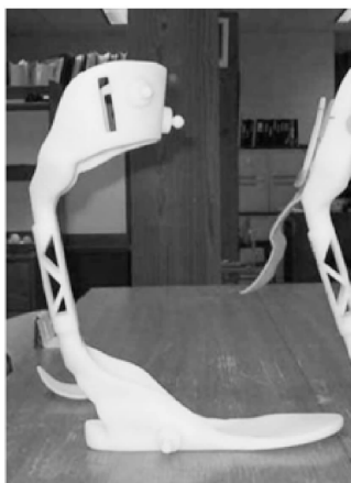
图 3 SLS 制备的脚踝校正支架
