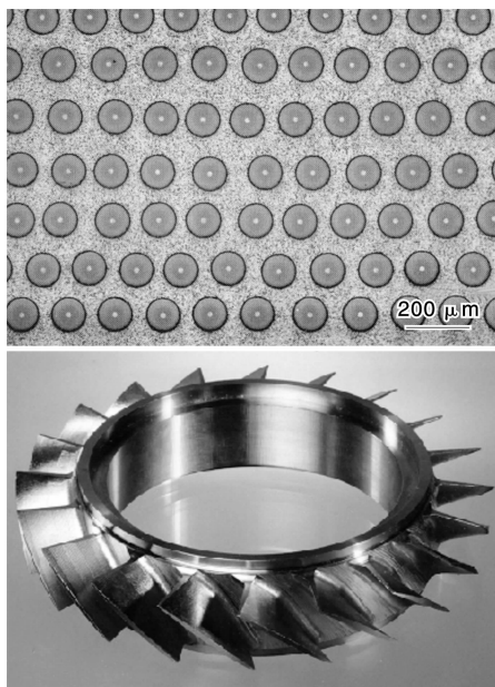
图 7 Rolls-Royce 公司研制的 \text{SiC}_f/\text{IMI834} 复合材料和整体叶环
