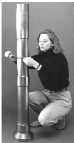
图 8 GE 公司研制的 \text{SiC}/\text{Ti} 复合材料低压涡轮轴
