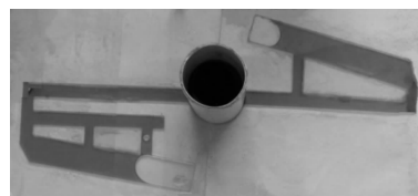
图7 水力学模拟实验铸型
