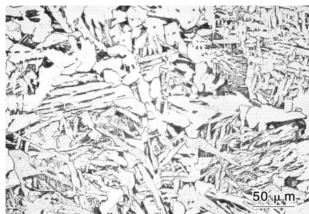
图2 大线能量焊接系列钢 100 kJ/cm 焊接 CGHAZ 典型光学组织
