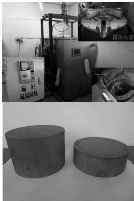
图 2 YAl 2 颗粒增强 Mg-Li 基复合材料熔炼系统及铸锭
