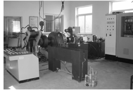
图4 DZJ-350 型靴旋转式连续铸挤机
