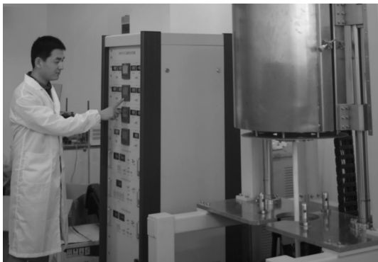
图 1 自主研发的化合物半导体晶体生长设备
