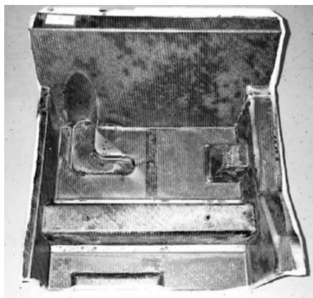
图4 采用热塑性或热固性树脂传递模塑(RTM)工艺制备的整体底盘
