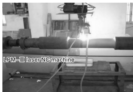
图 2 激光技术对减阻器进行再制造
