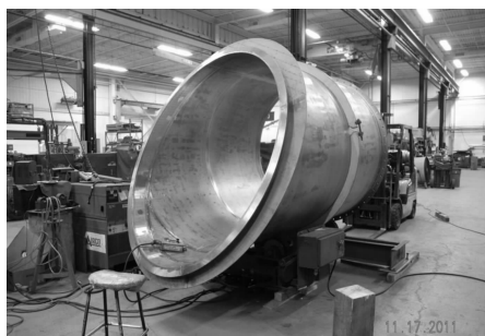
图2 美军自由级濒海战斗舰(LCS)主燃气轮机Ti制排气管道照片(取自 Titanium Fabrication Corp. 网站)
