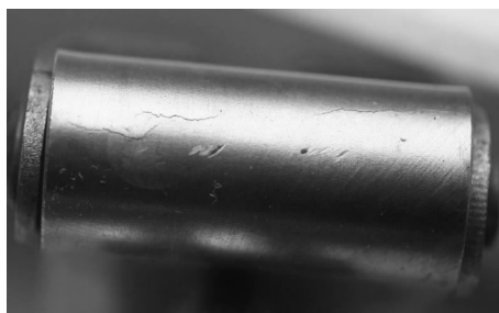
图11 2Cr13Mn9Ni4 不锈钢卡箍应力腐蚀裂纹外观形貌
