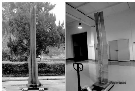
图 1 LSF 制造的 C919 大型客机中央翼肋缘条
