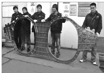
图 2 采用 LSF 制造的飞机加强框
