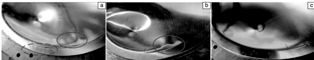
图 11 整体压边方式下, 不同压边力下, 板料起皱情况 (虚线: 法兰区; 实线: 悬空侧壁区): (a) 6.2 kN, (b) 8.4 kN, (c) 21.6 kN
