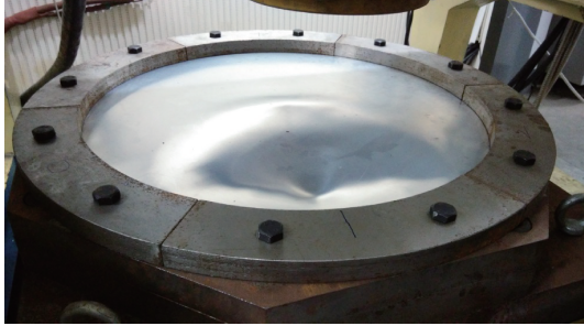
图 9 分块压边条件下的实验工装
