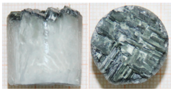
图 4 添加助熔剂后生长的 KNN-0.05LN 晶体侧视图 (左) 及俯视图 (右)
