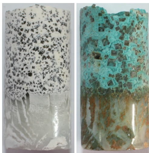
图 3 添加助熔剂后生长的 KNN-0.05LN 晶体 (左) 及 KNN-0.05LN:Mn 晶体 (右)
