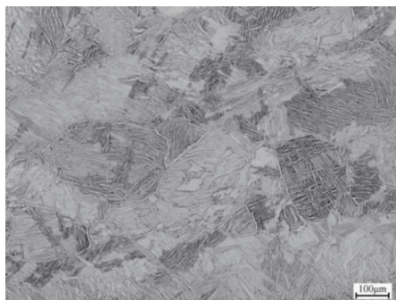
图 1 TC4ELI 钛合金管材的金相照片
