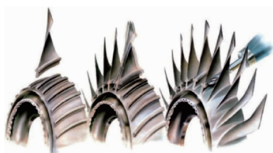
图 9 整体叶盘线性摩擦焊加工过程 [36]
