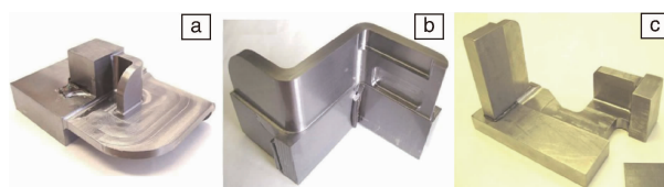
图 11 线性摩擦焊接近净成形不同产品 [43]
