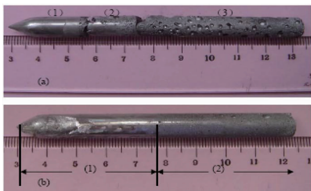
图 11 空间 (a) 和地面 (b) 环境下 \text{Bi}_2\text{Se}_{0.21}\text{Te}_{2.79} 合金的凝固试样 [39]
