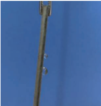
图 6 沉积了平均直径为 14.8 \mu\text{m} 颗粒的 6063 铝合金工件表面的水滚动角超过 90°
