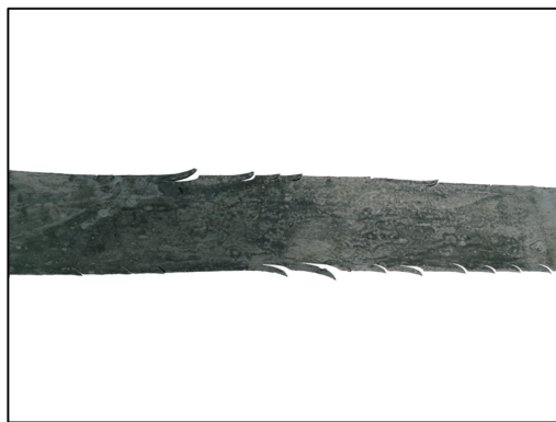
图 2 WCu20 合金板轧制时产生的边部开裂 [19, 20]
