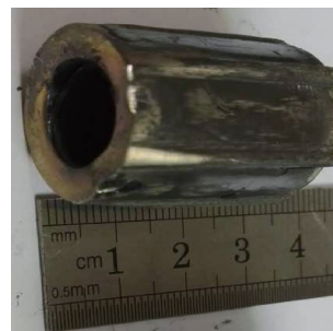
图 3 旋转反挤压成形构件照片
