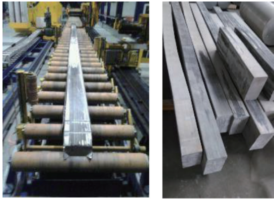
图 9 横截面积为 22 * 11 cm 2 的 Mg-Gd-Y-Zn-Zr 合金挤压板材 Fig. 9 Mg-Gd-Y-Zn-Zr extrusion plates with cross-sectional area of 22 * 11 cm 2
