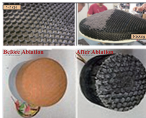
图 3 Avcoat 结构及烧蚀前后形貌 [16]
