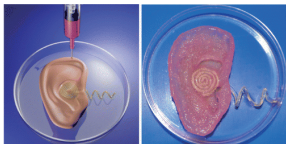
图5 3D打印仿生人耳 [71]
