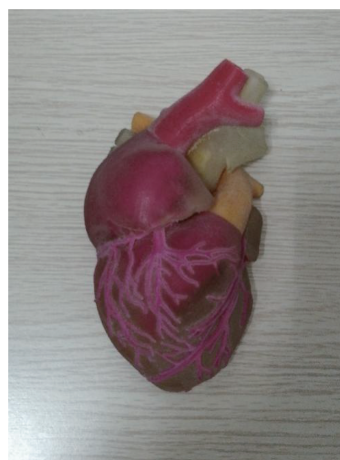
图1 采用Polyjet技术制造的人体心脏模型
