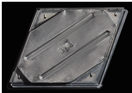
图 10 亚轨道单级入轨火箭运载器 X-33 防热隔热板 (由高温合金和 Ti1100 高温钛基合金组成) [56]
