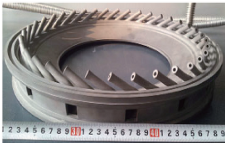
图 1 粉末冶金工艺成型的 Ti_2AlNb 部件 [14]
