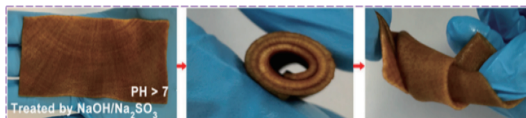
图 4 经 NaOH 和 Na 2 SO 3 处理得到的柔性木质膜 [35]
