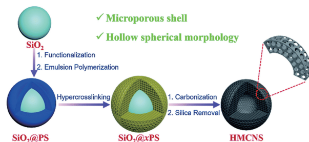
图 27 具有良好电化学性能的空心多孔碳纳米球的制备 [55]
