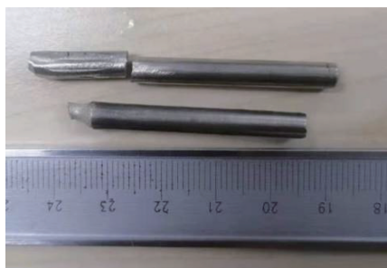
图 1 旋锻过程中横断的 A4 钎料
