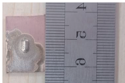
图 6 F3 钎料在 675 °C 时对 CuAgZr 基材的润湿性 Fig. 6 Wettability of F3 filler on CuAgZr substrate at 675 °C
