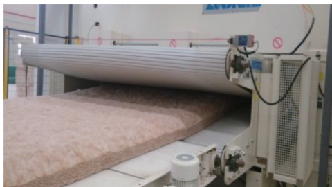
图 8 各向异性共混热致麻纤维复合材料制备生产线
