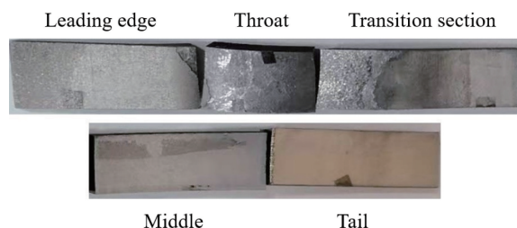
图 3 推力室喷管火焰冲刷试验后宏观形貌
