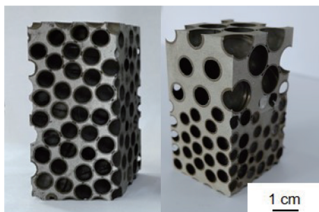
图 7 钢质空心球铝合金基复合材料样件
