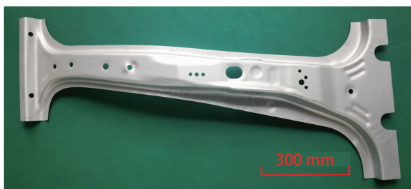
图 9 7075 铝合金热成形 B 柱加强板零件
