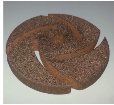
图 12 SLM 制备的 Cu-Cr 电触头 [68]
