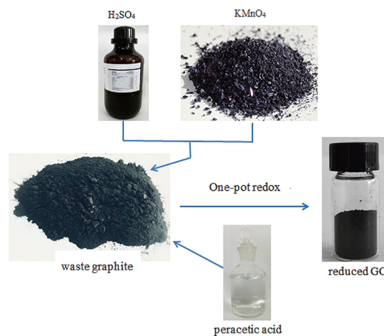
图 12 一锅氧化还原法制备还原氧化石墨烯(rGO) [58]
