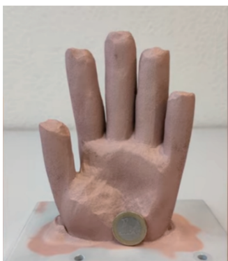
图 8 冷喷涂增材制造技术打印的手掌模型 [52]
