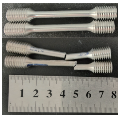
图 5 常温拉伸试验前后试样实物照片
