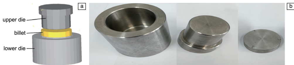
图 9 反挤压实验示意图(a)与模具和坯料的照片(b)
