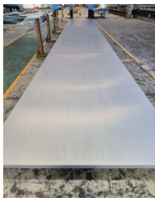
图 5 西部钛业有限责任公司生产的海洋用 TC4 合金超大板材 Fig. 5 Extra-large marine used TC4 alloy plates produced by Western Titanium Technologies Co., Ltd.
