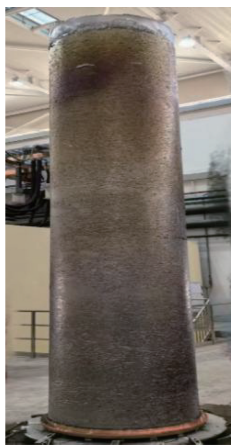
图 4 西部超导材料科技股份有限公司制备的 15 t 级 Ti80 合金铸锭 Fig. 4 The 15 t ingot of Ti80 alloy prepared by Western Superconducting Technologies Co., Ltd.
