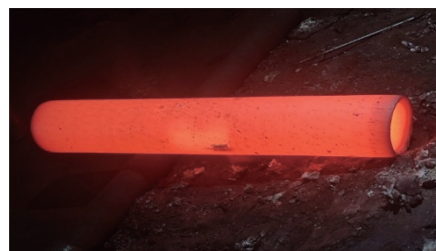
图 6 \Phi 406 \text{ mm} \times 10 \text{ mm} \times 5500 \text{ mm} TA24 合金管材 Fig. 6 TA24 alloy pipe with dimensions of \Phi 406 \text{ mm} \times 10 \text{ mm} \times 5500 \text{ mm}
