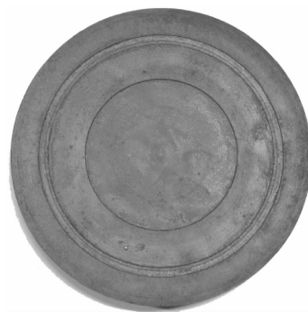
图3 FGH98 I 合金双重组织热处理无开裂盘
