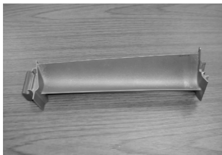
图 4 波音 787 引擎上 Ti-48Al-2Nb-2Cr 合金铸造低压涡轮机叶片
