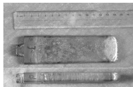
图 14 宽厚比 3:1 冷坩埚定向凝固的 Ti-46Al-0.5Si-0.5W 扁锭
