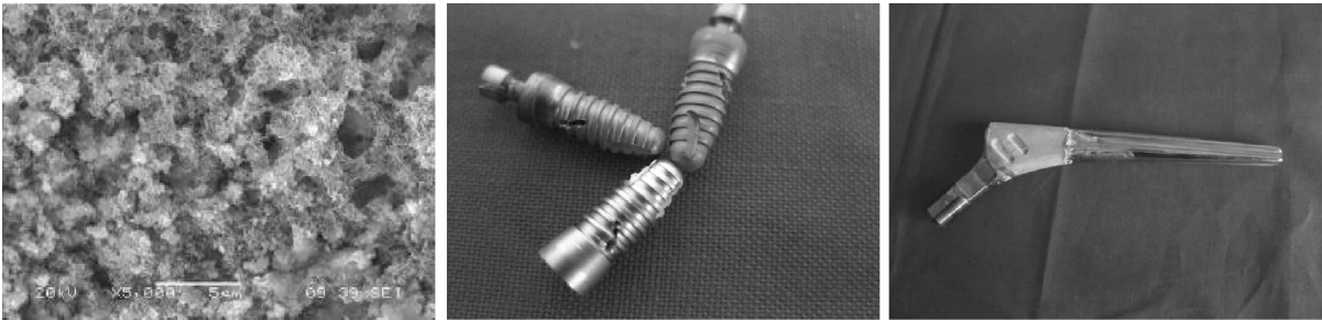
图 5 新型 TLM 钛合金表面功能梯度 TiO 2 /HA 复相涂层 Fig. 5 Functional TiO 2 /HA composite coatings on the TLM titanium alloy
