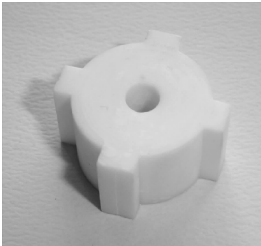
图 4 水萃取脱脂后烧结的氧化锆齿轮状部件 Fig. 4 Sintering gear-like zirconia parts after water extraction debinding
