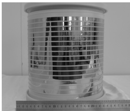
图 3 10 米隔离层长带的实物照片
